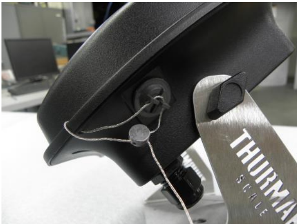
Typical seal for models TS250-1, TS250-3, TS255-1, and TS255-3 / Scellage typique des modèles TS250-1, TS250-3, TS255-1, et TS255-3
