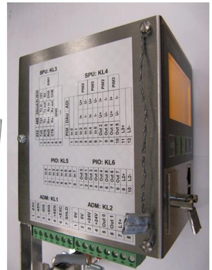
Typical seals on model IT2000M / Scellés typiques sur le modèle IT2000M
