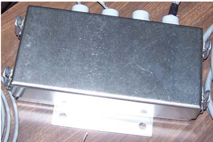
Typical sectional controller model ACC-2000-1A / Contrôleur sectionnel typique modèle ACC-2000-1A
