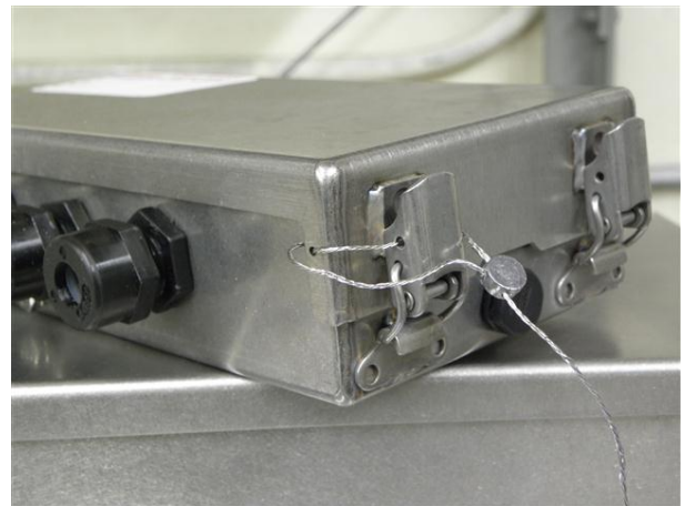
Sealing of sectional controller model ACC-2000-1A / Scellage du contrôleur sectionnel modèle ACC-2000-1A
