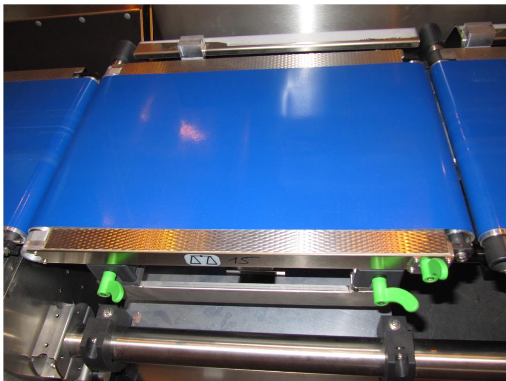
Typical load receiving element without draft shield / Dispositif peseur et récepteur de charge typique sans pare-vent
