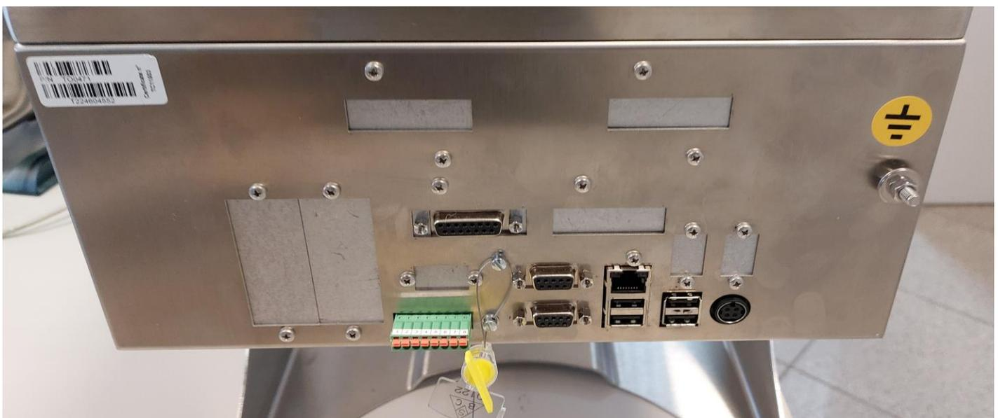
Additional calibration switch sealing for model DD1050IC Skynet/ Scellage supplémentaire du bouton d'étalonnage du modèle DD1050IC Skynet
