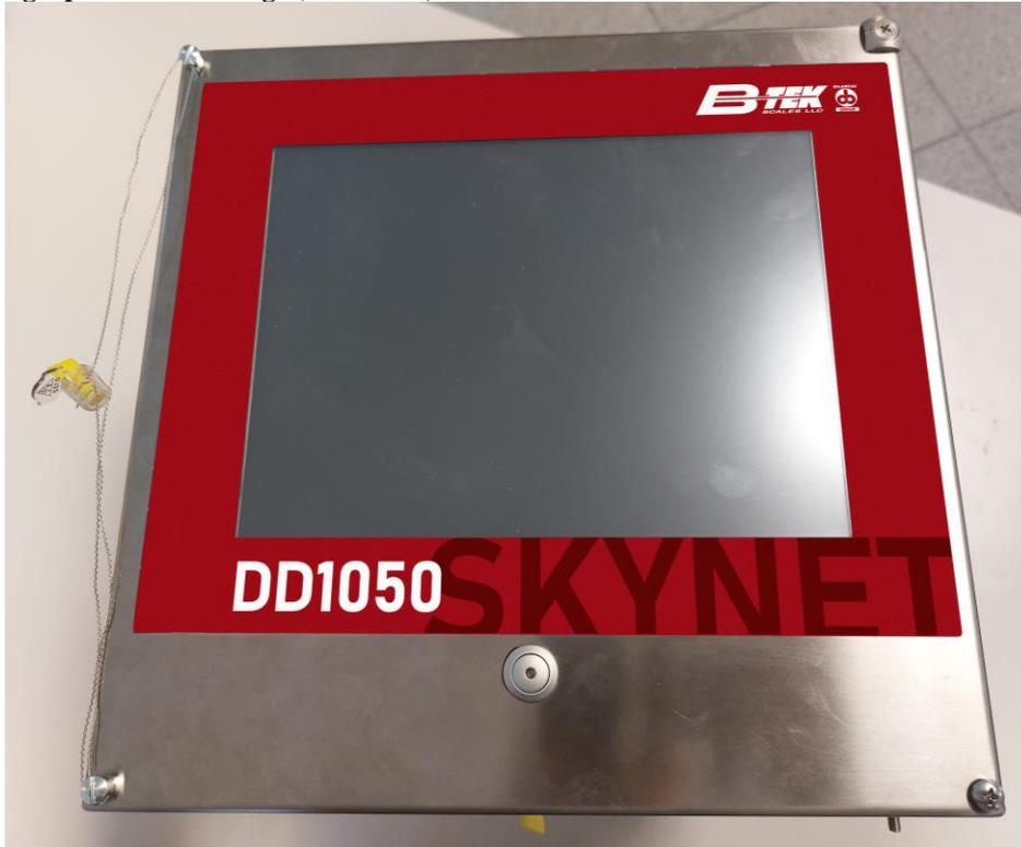
**Sealing for model DD1050IC and DD1050I Skynet / Scellage du modèle DD1050IC et DD1050I Skynet**
