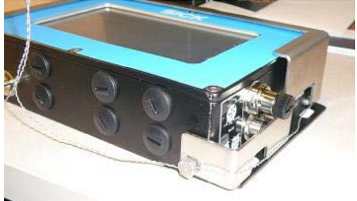
**Typical sealing for the SIU display / Scellage typique pour l'affichage SIU****SECTION 9 - Evaluated by**
