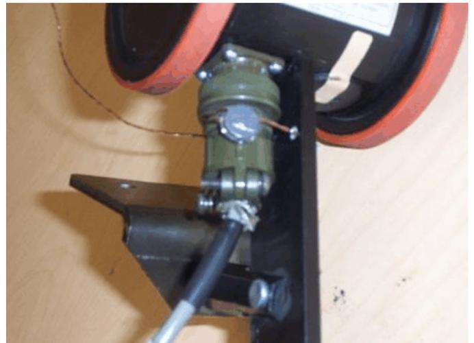
**Typical tachometer sealing / Scellage typique du tachymètre**
