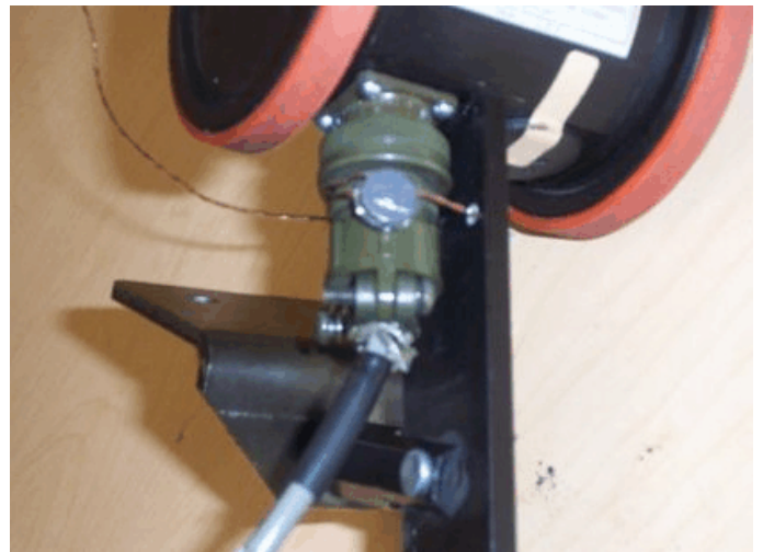
Typical tachometer sealing / Scellage typique du tachymètre
