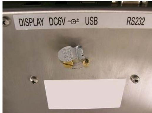
Typical wire and seal method / Méthode typique de scellage avec fil et scellé
