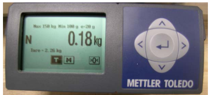
Typical operator's display (LCD matrix) / Affichage typique destiné à l'opérateur (ACL à matrice)
