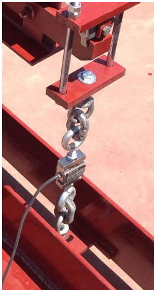
Typical load cell mounting / Montage typique de la cellule de pesage
