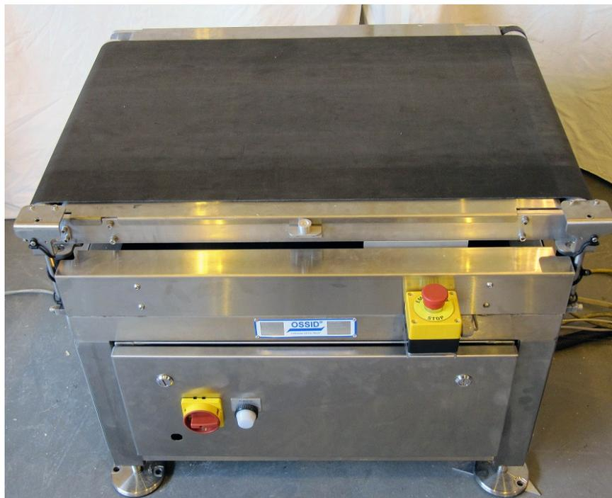
**Typical Weighing Element / Dispositif peseur typique**
