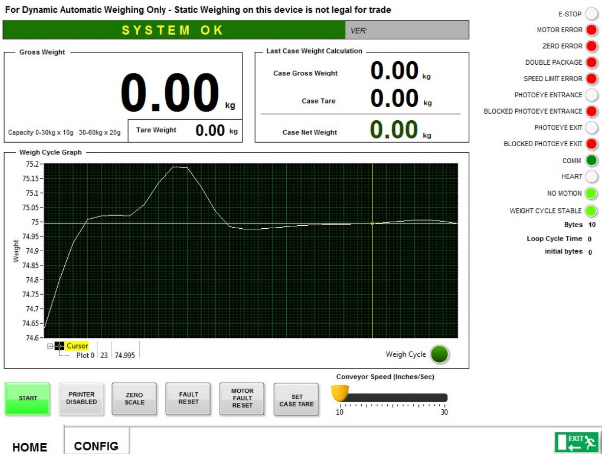
**Typical Weight Display and Operator Controls / Affichage typique du poids et contrôles destinés à l'opérateur**
