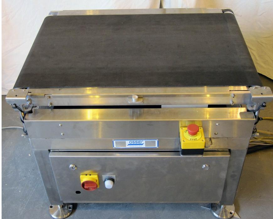
**Typical Weighing Element / Dispositif peseur typique**
