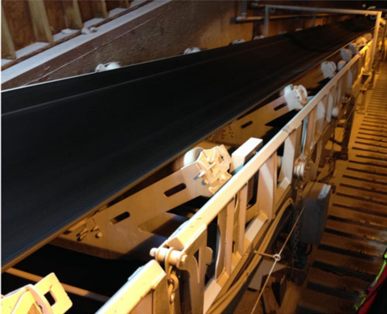
**Typical weigh frame installation / Installation typique du châssis de pesage**
