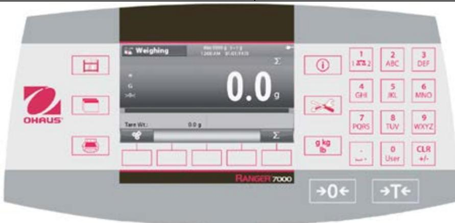
**Typical Operator Display and Controls Terminal. / Terminal typique avec écran et contrôles pour opérateur.**
