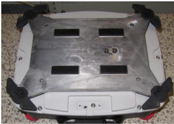
Typical sub-platter for models R71MD15, R71MD35, R71MHD15, R71MD60 and R71MHD35. / Sous-plateau typique des modèles R71MD15, R71MD35, R71MHD15, R71MD60 et R71MHD35.
