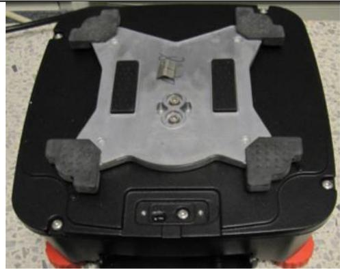
Typical sub-platter for models R71MHD3 and R71MHD6. / Sous-plateau typique des modèles R71MHD3 et R71MHD6.
