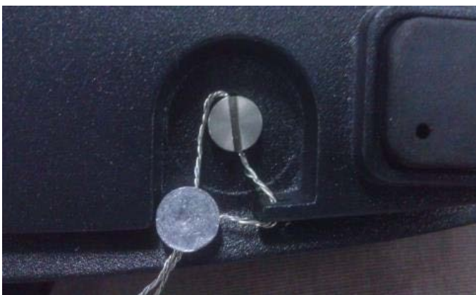
Typical Terminal sealing method when using a secondary LRE. / Méthode de scellage typique du Terminal lorsqu'un ERC secondaire est utilisé.
