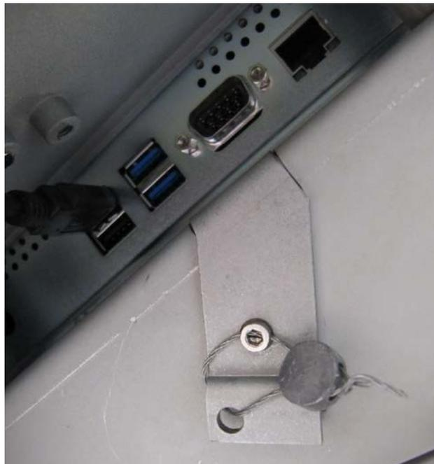
Typical sealing method for model KH II 400-#. / Méthode de scellage typique pour le modèle KH II 400-#.
