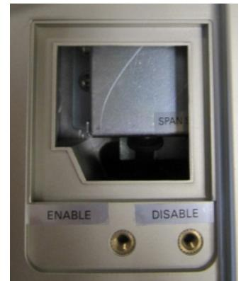
**Typical calibration switch access / Mode d'accès à l'interrupteur d'étalonnage typique**
