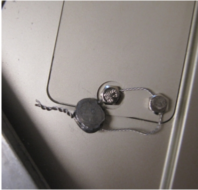
Typical wire and seal method for calibration switch access / Méthode typique de scellage avec fil et scellé pour l'accès à l'interrupteur d'étalonnage
