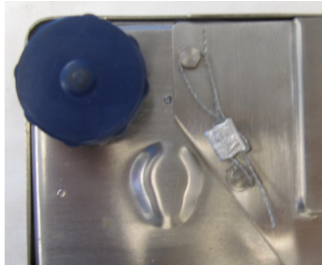
Typical mandatory seal method for the cable of the modular weighing and load receiving element / Méthode typique obligatoire de scellage pour le câble du dispositif peseur et récepteur de charge modulaire (SM-5500B Split Alpha, SM-5500B Split G)
