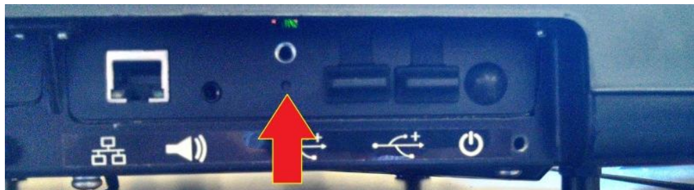
Typical Calibration Switch Location / Emplacement typique du bouton d'étalonnage
