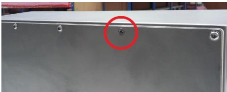
Typical counter-sunk screw (must be covered with a paper seal) / Vis à tête fraisée typique (doit être recouvert d'un scellé de papier)
