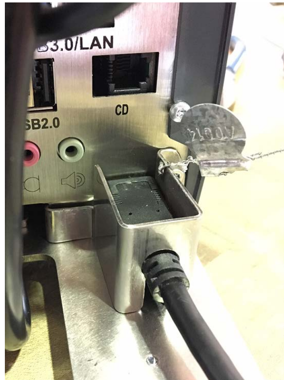
Typical XC 300 load cell cable sealing behind the indicator-printer/ Emplacement typique d'une scellé physique pour du câble de la cellule de pesage derrière l'imprimante-indicateur pour le modèle XC 300
