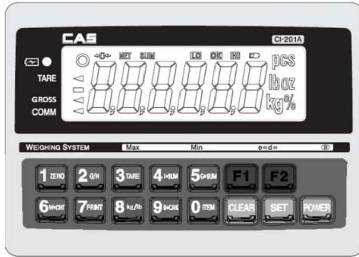
**Typical keys and annunciators for of model CI-201A / Touches et voyants typiques du modèle CI-201A**
