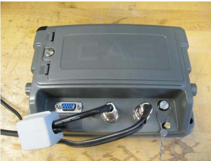
**Typical seal for models CI-200A and CI-201A / Scellage typique des modèles CI-200A et CI-201A**
