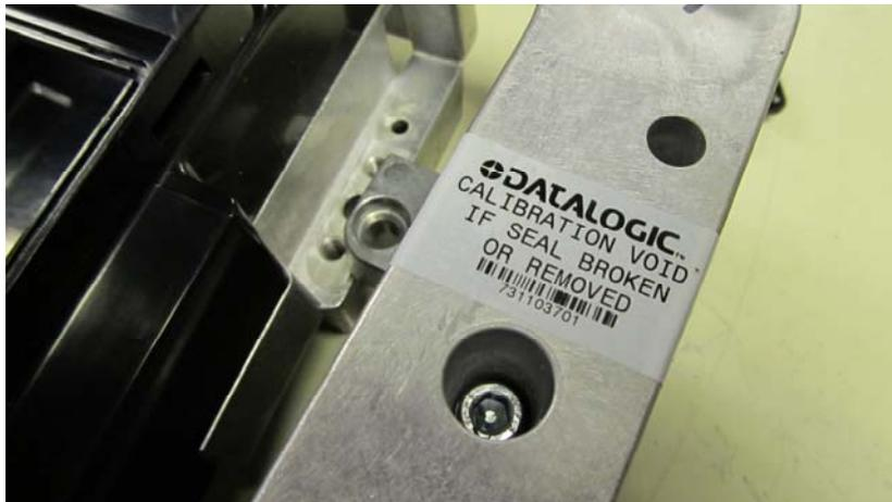
Sealing of subframe mounting bolt hole / Scellage d'une des vis de montage du sous châssis.
