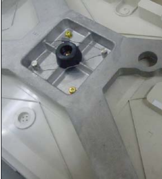
Typical housing seal for 250 mm x 400 mm platters / Scellage typique du boîtier pour les plateaux de 250 mm x 400 mm
