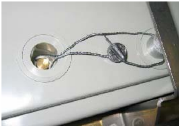
Typical calibration button seal for 250 mm x 300 mm platters / Scellage typique de la touche d'étalonnage pour les plateaux de 250 mm x 300 mm
