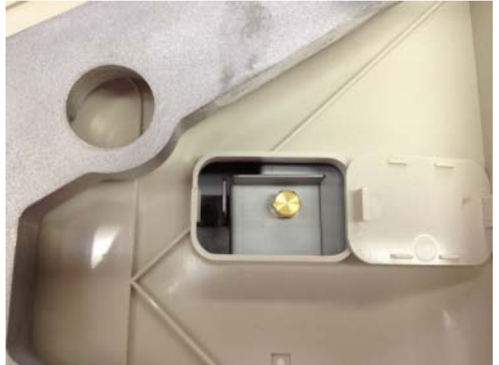
Typical calibration button seal for 250 mm x 400 mm platters / Scellage typique de la touche d'étalonnage pour les plateaux de 250 mm x 400 mm
