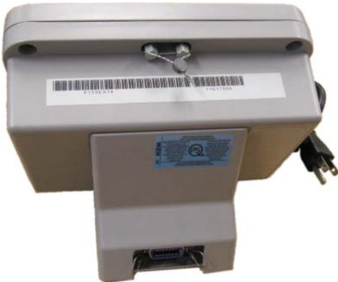
Typical sealing of models DI-166 and DI-166SS / Scellage typique des modèles DI-166 et DI-166ss
