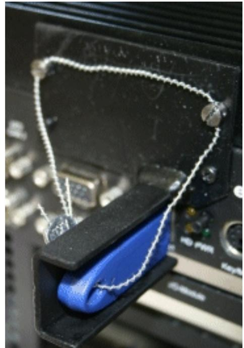
**CPU sealing / Scellage de l'UC**
