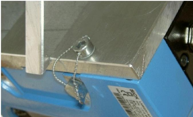
**Sensor head sealing / Scellage du capteur**
