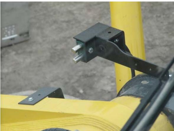
**Typical weighing zone sensor / Interrupteur de zone de pesage typique.**
