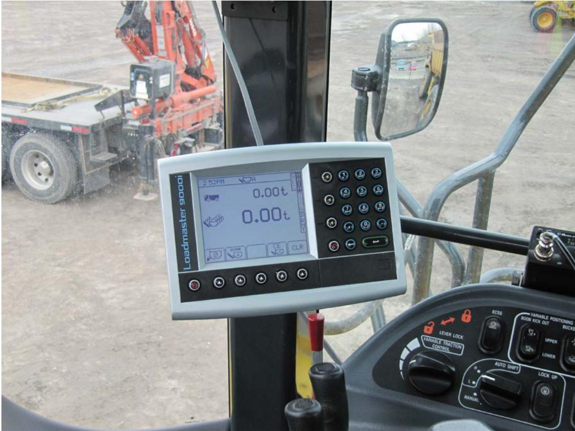
**Typical model LM9000i display / Affichage typique du modèle LM9000i**
