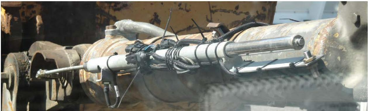
**Typical bucket position switches / Interrupteurs typiques de position de godet**
