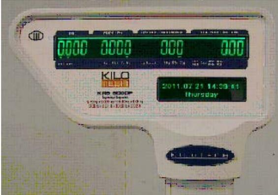
**Alternate operator & customer display KRS 3000P / Affichage destiné à l'opérateur et aux clients alterné KRS 3000P**
