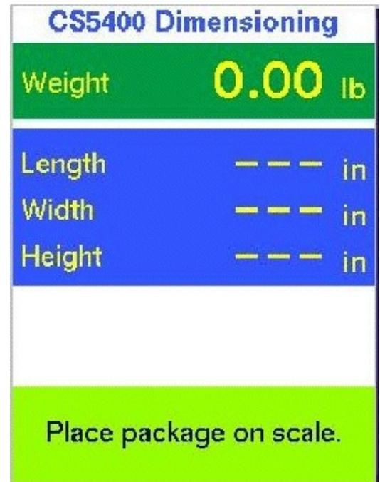
Operator's display showing the weight, length, width, height and ready condition / Affichage destiné à l'opérateur indiquant le poids, la longueur, la largeur, la hauteur et la condition d'état prêt
