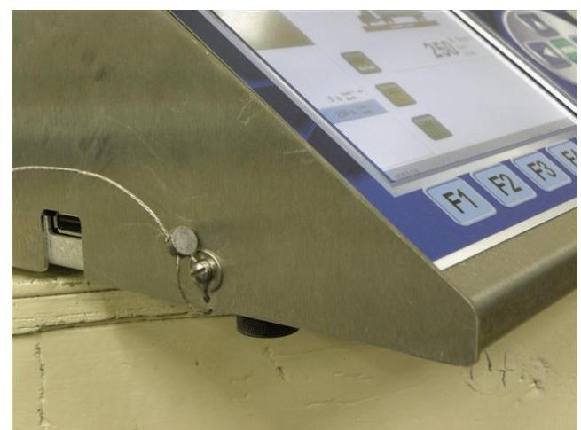
**Typical seal for model FB2550-XXX / Scellé typique du modèle FB2550-XXX**
