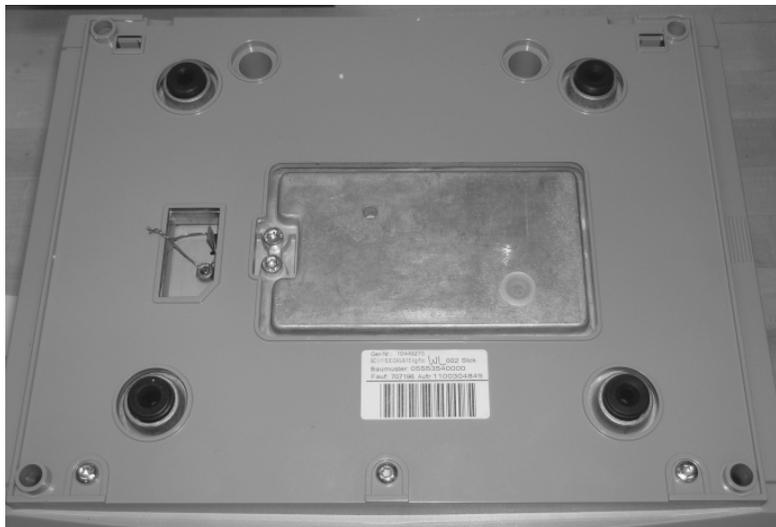
**Typical SCII 100, SCII 200 and SCII 800 sealing and sub-platter / Scellage et sous-plateau typique du SCII 100, SCII 200 et SCII 800**
