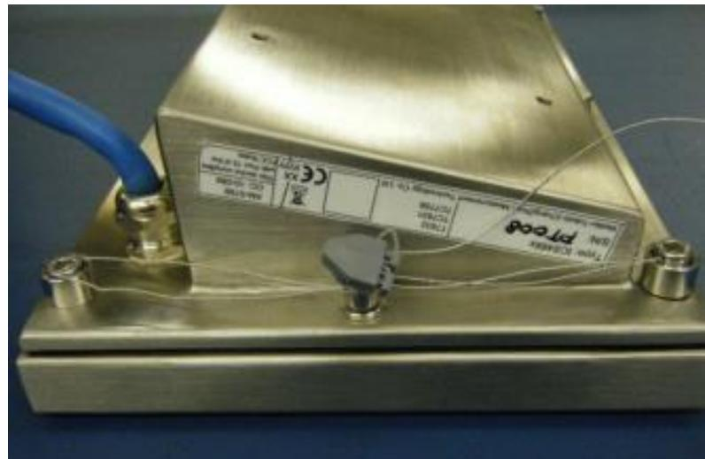
Typical wire seal for model ICS426x or ICS466x / Scellé fil typique pour le modèle ICS426x ou ICS466x
