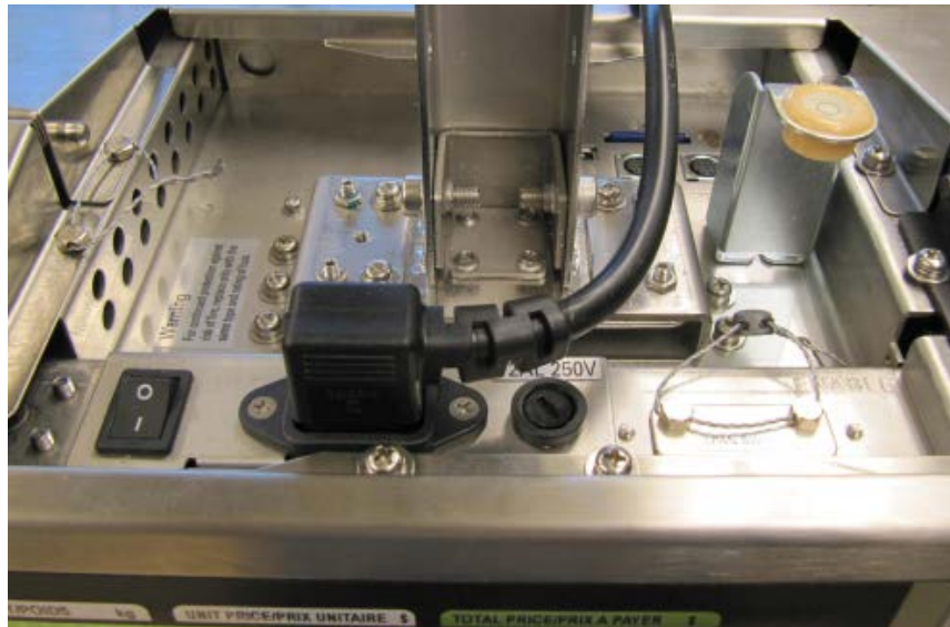
Typical housing and calibration switch seals of model SM-5000H / Scellés typiques du boîtier et de l'interrupteur d'étalonnage du modèle SM-5000H
