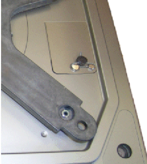
Typical calibration switch seal for all approved models except for model SM-5000H / Scellé typique de l'interrupteur d'étalonnage de tous les modèles à l'exception du modèle SM-5000H
