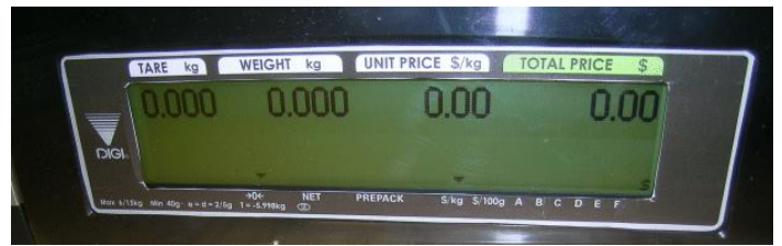
Typical customers' display for SM-5400 series models and SM-5000H / Affichage destiné aux clients typique des modèles du séries SM-5400 et SM-5000H
