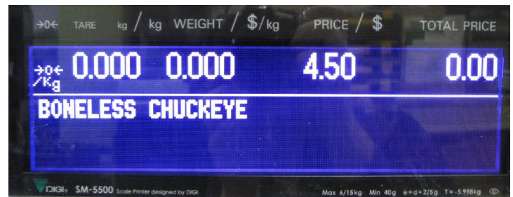
Typical customers' display for SM-5500 series models / Affichage destiné aux clients typique des modèles du séries SM-5500
