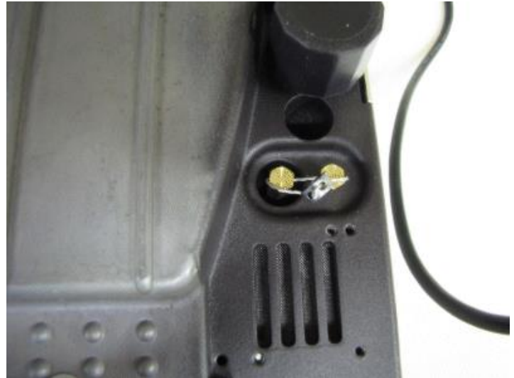
Typical housing seal for all approved models except for model SM-5000H / Scellé typique du boîtier pour tous les modèles approuvés à l'exception du modèle SM-5000H
