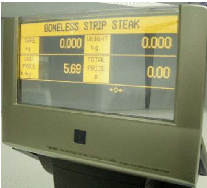
Typical customers' display of models SM-5500P EL and SM-5500EV EL / Affichage destiné aux clients typique des modèles SM-5500P EL et SM-5500EV EL
