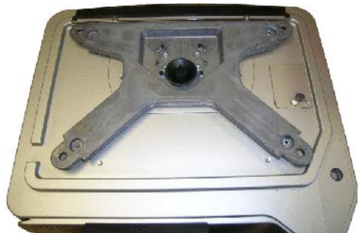
Typical subplatter of all approved models except for model SM-5000H / Sous-plateau typique de tous les modèles approuvés à l'exception du modèle SM-5000H
