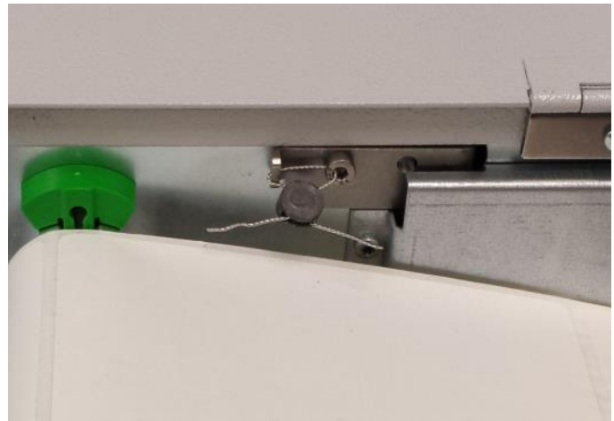
Wire seal inside controller-printer housing / Scellé physique à l'intérieur du contrôleur-imprimante
