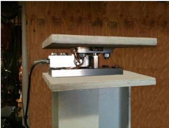
Photo of typical load cell mounting / Photo du montage typique des cellules de pesage
