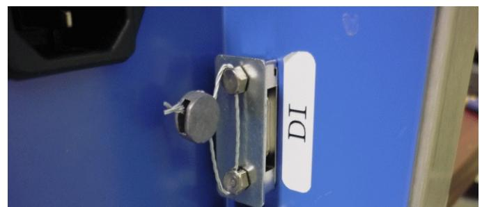
Separate indicator port sealing / scellage du port pour indicateur séparé
