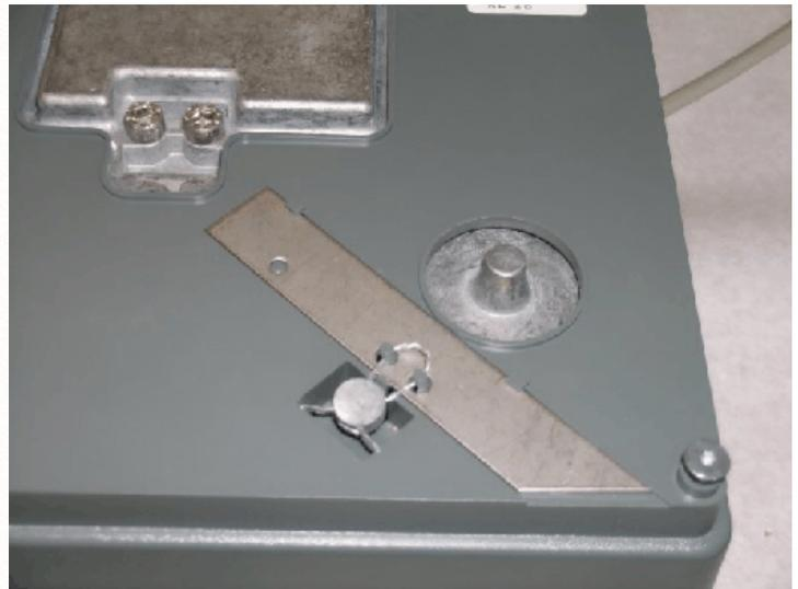
Typical sealing of calibration switch and housing of models K 100 G and Type 18-A / Scellage typique du commutateur d'étalonnage et du boîtier des modèles K 100 G et Type 18-A
