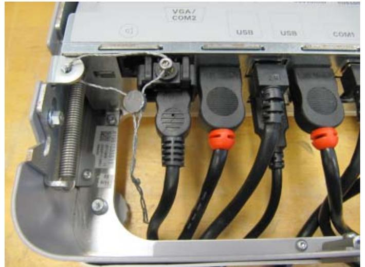
Typical seal of the the load cell cable to the KF computer module / Scellage typique du câble de la cellule de pesage à l'ordinateur du modèle KF
