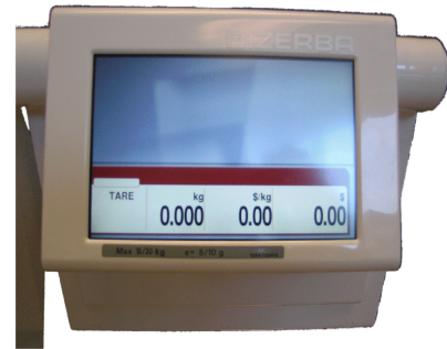
Typical customer display for KH series / Affichage typique destiné au client pour la série KH
