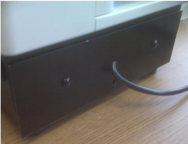
**Cover plate for sealing LRE to indicator / couvercle couvrant la connection entre le récepteur de charge et le dispositif indicateur**
