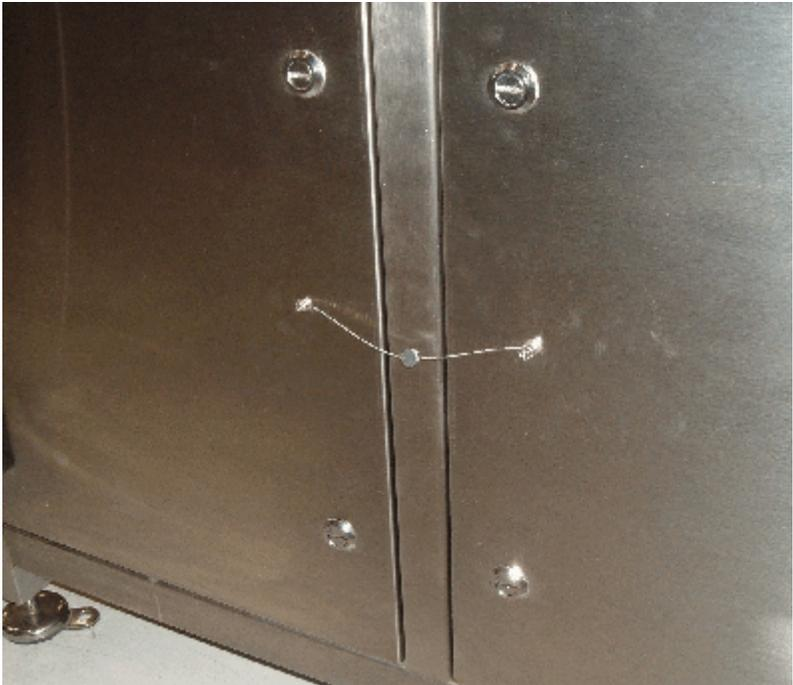
**Front and Rear Double Door Sealing / Scellage des portes à deux battants avant et arrière**
