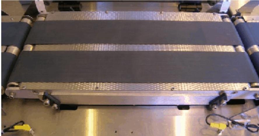
**Typical Weighing Element / Dispositif peseur typique**
