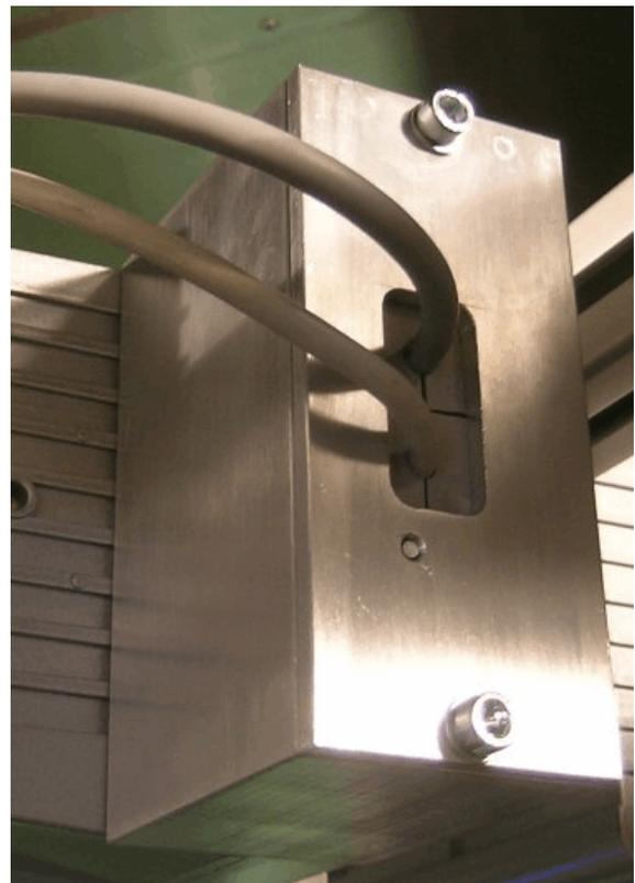
Connector sealing on dimensioning head / Scellage des connecteurs à la tête de mesure
