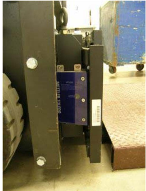
**Typical model VFS220 junction box / Boîte de jonction typique modèle VFS220**
