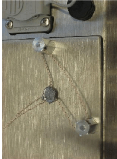
Typical sealing method/ Méthode de scellage typique
