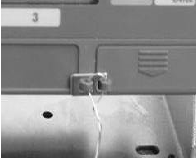
Model AD-4406 sealing method / Méthode de scellage du modèle AD-4406
