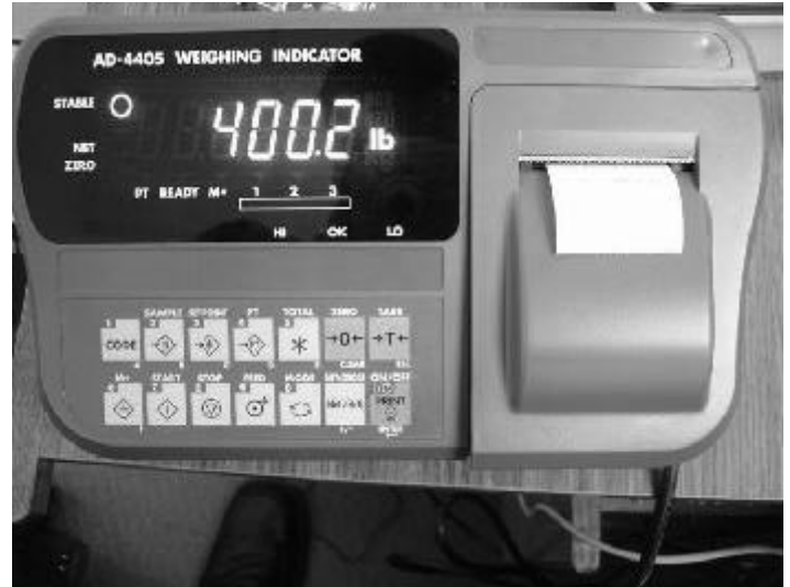
Model AD-4405 with optional printer / Modèle AD-4405 avec imprimante en option
