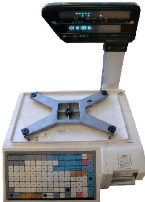
Typical model AC-4000\* sub-platter / Sous
