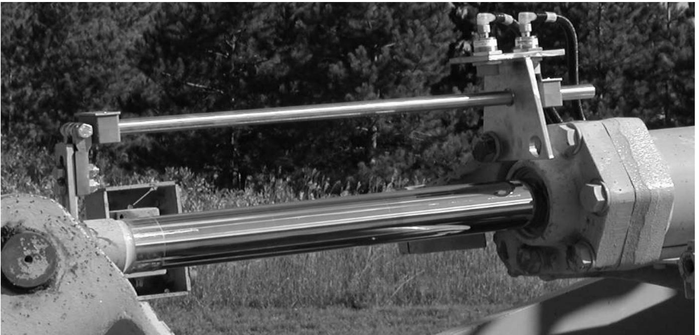
**Open/closed bucket switch / Interrupteur d'ouverture et de fermeture du godet**
