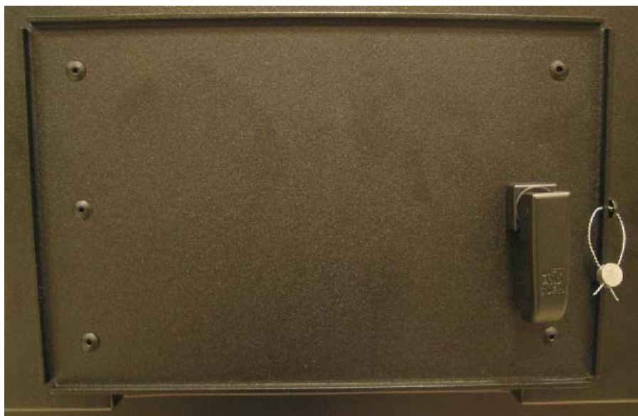
Sealing of communication port locking panel / Scellage du panneau de verrouillage du port de communication
