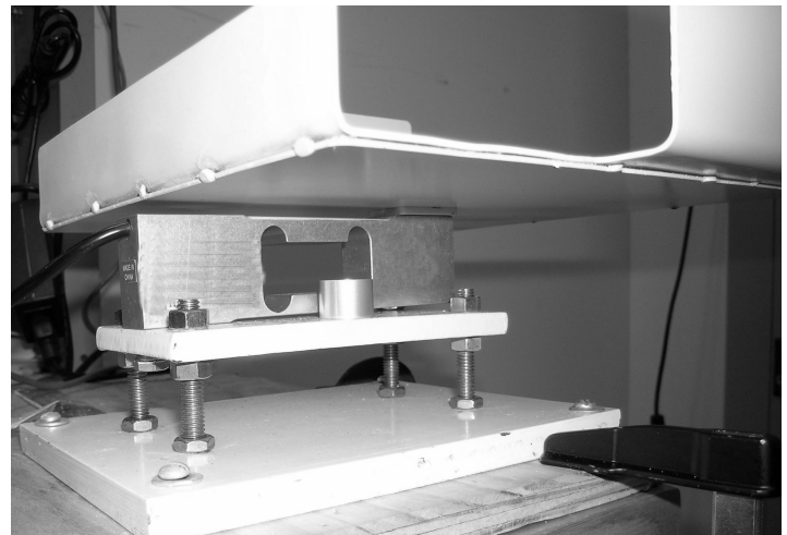
Load cell assembly with platter / Montage de la cellule de pesage avec un plateau
