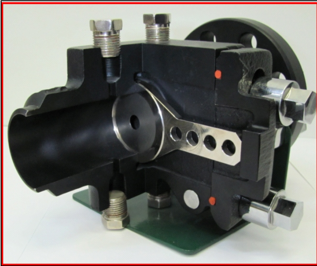
Vue en coupe du raccord à orifice à chambre simple NuFlo de Cameron (modèle 4042....) Cutaway view of Cameron's NuFlo Single Chamber Fitting, Model 4042.....
