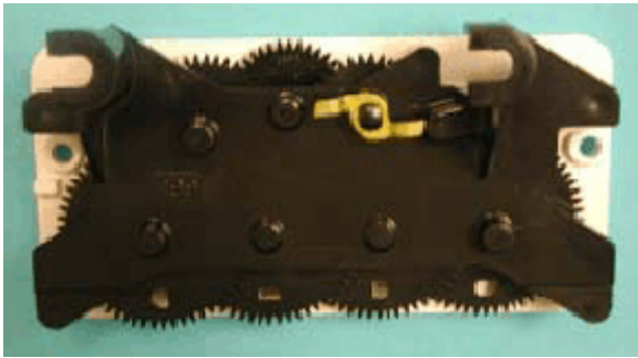
Figure 1. Index with old dog / Indicateur avec ancien organe d'entraînement
